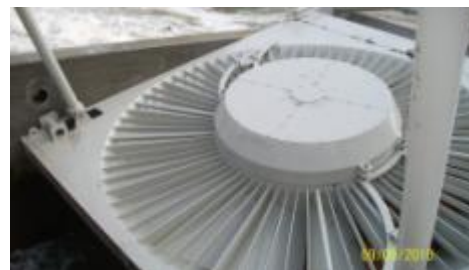
Sollevamento Idrraulico della VLH di Montodine (Italia)
