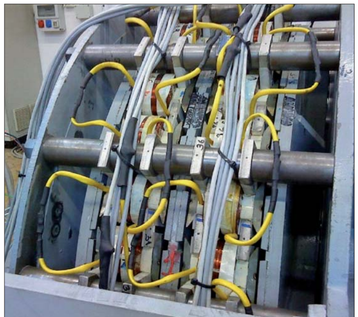
Figura 10 Macchina a flusso assiale dotata di 2 moduli, con i dati di Tabella 2
