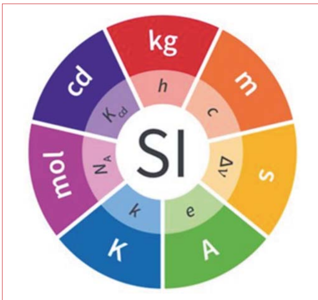
Figura 1 Il nuovo Sistema Internazionale delle unità di misura
