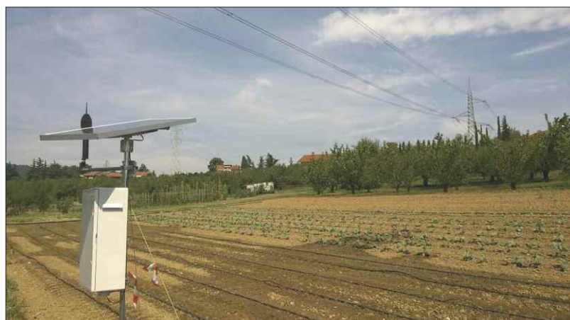
Figura 4 Equipaggiamento per la misurazione del livello di pressione sonora durante la campagna di acquisizione dei dati.
