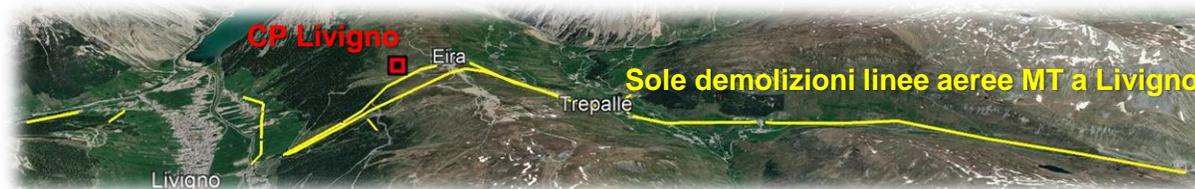
Complessivamente nel comune di Livigno verranno posati oltre **32 km** di nuove linee MT in cavo interrato che andranno a sostituire circa 11 km di linee aeree.
